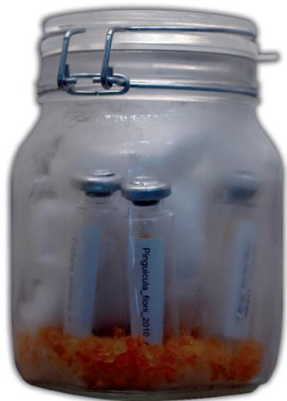
La fine del processo di deidratazione vede la conservazione finale del germoplasma in flaconi di vetro trasparenti, unitamente a gel di silice e cotone idrofilo, posizionati in congelatore ad una temperatura di  $-20^{\circ}\text{C}$ . I flaconi contenenti i semi verranno a loro volta posizionati all'interno di altri contenitori (barattoli con chiusura ermetica), in cui un indicatore di umidità permetterà di monitorare l'ermeticità dello stesso.
